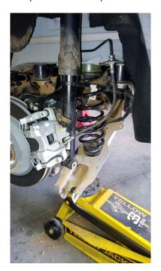
Step 21. Reinstall lower shock bolt.
